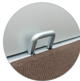
8 bindhaken binnenzijde laadbak
