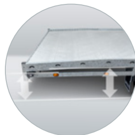
Verlaagde laadvloer aan achterzijde
