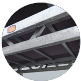
Robuust vakwerkchassis uit kokerprofielen
