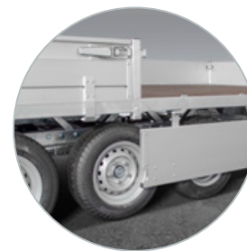
Gedeelde zijwanden vanaf 5 meter lengte
